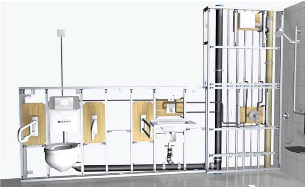
Geberit Installationssysteme in der barrierefreien Anwendung. Alle Geberit Barrierefrei-Lösungen finden Sie in der Broschüre Geberit Barrierefrei.
