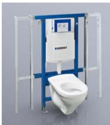
*Duofix Wand-WC mit variabler Breite für die flexible und rationelle Vorwandinstallation in Nischen oder zwischen zwei Wänden.*
