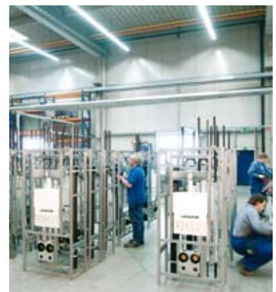
*Vorkonfektionierte Installationswände für die Optimierung aller Bauabläufe mit der Sicherheit von Geberit.*
