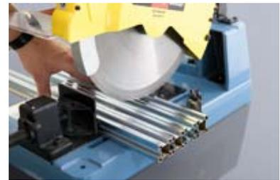
Rationelle Verarbeitung mit Kappsäge: Bis zu vier GIS Profile sind in einem Arbeitsschritt mit der Kappsäge ablängbar.
