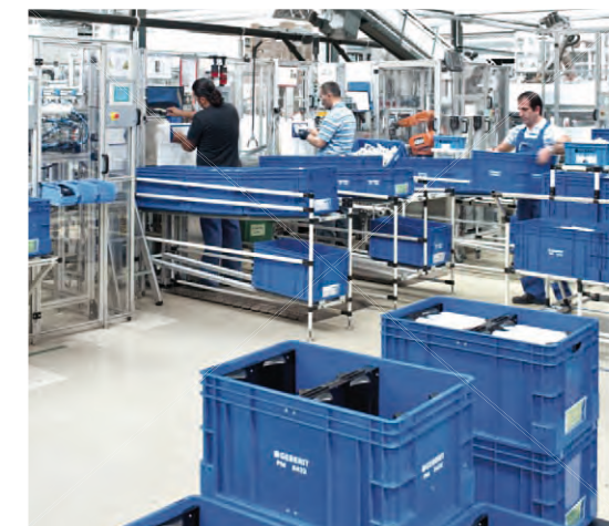
Pullgesteuerte Fließfertigung eines Spülkastens Teilezuführung zur Montagelinie über Kanban-Behälter
