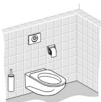
Fig. 266: Déclenchement du rinçage des WC sans contact manuel
